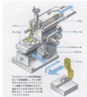
11. 一般的に形削り盤は、小型のものを加工するのに適しており、比較的取り扱いが容易で、平らな面の加工に使用される。 ( ○ )
