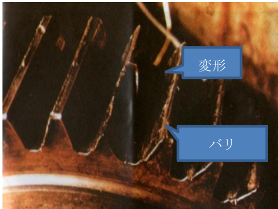
損傷名称 塑性流れ 損傷現象・原因 過大荷重および潤滑不良などによる歯面の変形
